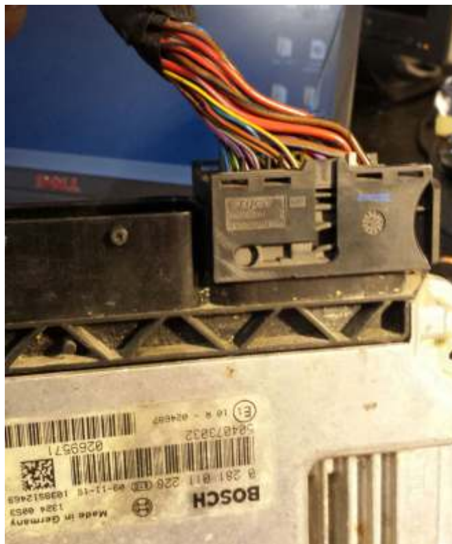
Dettaglio della connessione ECR dove eseguire il lavoro
