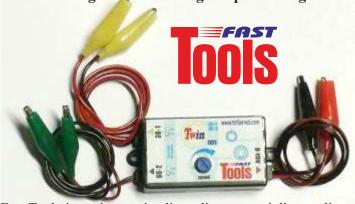
Fast Tools è una innovativa linea di generatori di segnali per la rilevazione di guasti nelle centraline ECU dei motori per autovetture, furgoni e veicoli industriali; in pratica, simula gli stessi segnali provenienti delle ruote foniche dei giri e della fase di un moderno motore termico.
